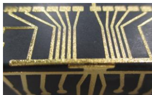
(2)ポリブタールアミド樹脂(密着強度: 7~15N/cm、CO 2 、YVO4 レーザー)
