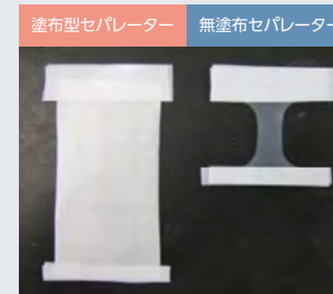
加熱試験後のセパレーター外観比較
