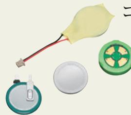
独自構造のコイン電池で、1円玉サイズながら140ミリアンペアの大電流放電を可能としました。正極電極をラッピングする内部ショート防止構造や、電池膨張を最小化するステンレス筐体の採用などで信頼性の確保にも注力。医療、物流など幅広い用途の小型通信機器向けに提供しています。
